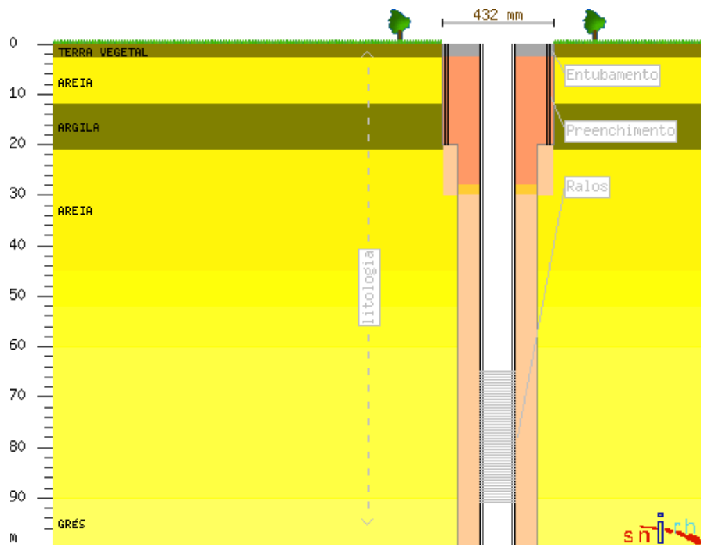
Figura 33 – Corte furo do piezómetro 484/9 - Carvalho.
